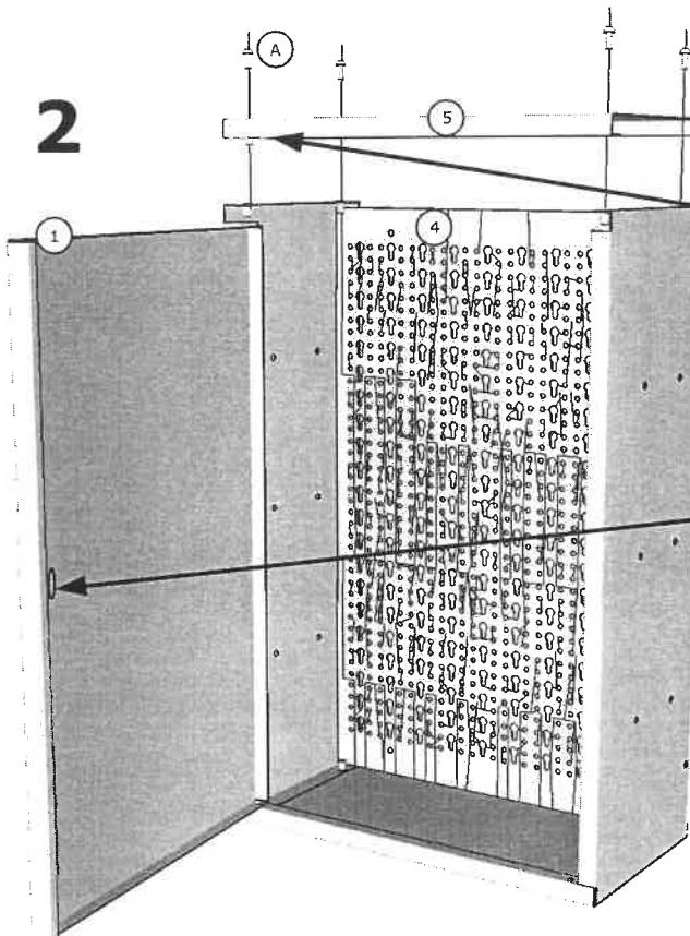
Sestavte tři samostatné skřínky dle obrázku 1 a 2. Nejprve nasadte do dílů(5) čepy(G,F,H) pro otočné zavěšení dvírek - lze určit směr otevírání. Čep provlékněte odspodu otvorem a zajistěte pojistným kroužkem. Sesadte boky a dno a sešroubujte(A). Vložte děrovaný zadní díl(4)NEšroubujte. Nasadte dvírka(1) na spodní čep a přiklopte horním dílem, sešroubujte. Namontujte zámky(6,7)do dvírek.
