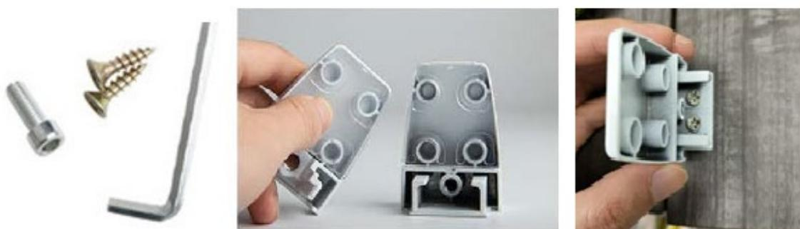
2. Do pierwszej części spinacza dołożyć parawan i zabezpieczyć go drugą częścią spinacza za pomocą śruby z płaskim łbem. Śruba z płaskim łbem jest do dyspozycji w dwu różnych wymiarach. Trzeba zastosować odpowiedni wymiar według typu zainstalowanej płyty. Śrubę dokręcić.
