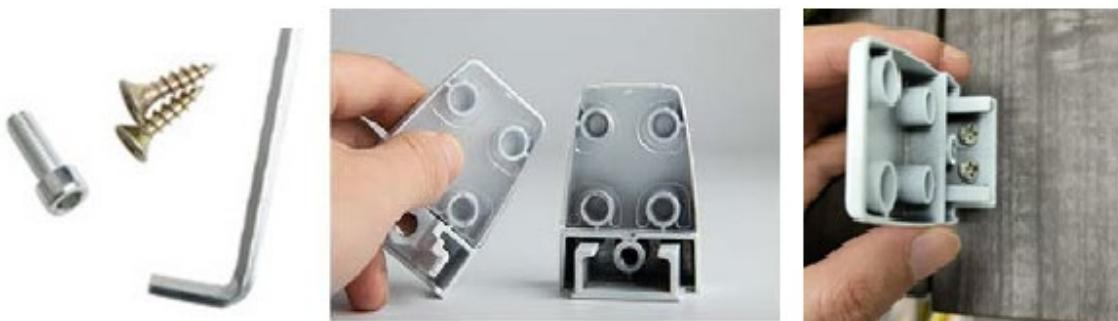
2. Befestigen Sie die Abschirmplatte am ersten Teil der Klammer und sichern Sie sie mit dem zweiten Teil der Klammer mit der Flachkopfschraube. Die Flachkopfschraube hat zwei verschiedene Größen. Verwenden Sie die richtige Größe für die Art der Platte, die Sie installieren. Ziehen Sie die Schraube fest.
