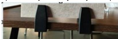
2. Do prvej časti klipu (k tej čo sa pripieva k stolu dosky) vložte paraván a zaistite ho druhou časťou klipu pomocou skrutky s plochou hlavou. Skrutku utiahnite.
