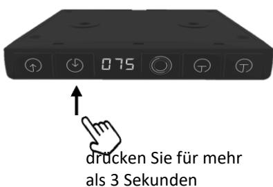
Drücken Sie in der niedrigsten Position oder nach Anzeige der Meldung „Schutz und Alarm“ den Abwärtspfeil für mehr als 3 Sekunden. Der Tisch wechselt in die niedrigste Position und sobald das Zurücksetzen abgeschlossen ist, passt er sich selbst an die voreingestellte Höhe an.
