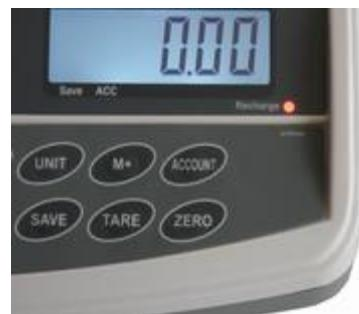
Jestliže váha bude používána bez řádného dobíjení, na displeji se ukáže kontrolka u symbolu „BATERIE“. Váha bude pracovat ještě po dobu cca 10 hodin a poté se automaticky vypne. Prosím dobíjejte akumulátor včas nebo váha nebude fungovat. K dobití akumulátoru připojte k váze přiložený adapter. Dobití na plnou kapacitu trvá cca 12 hodin. Váha má provoz na akumulátor cca 100 hodin.
