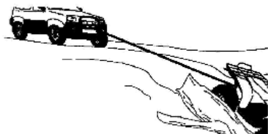
Jednoduché zapojení lana
