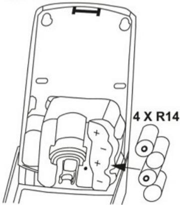
Otevřete kryt prostoru na baterie, vložte baterie a kryt zaklapněte.
