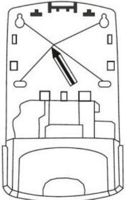
Přiložte dávkovač na zeď a vyznačte si montážní otvory.
