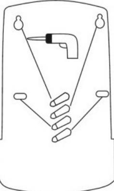
Vyrtejte otvory a do otvorů vložte hmoždinky.
