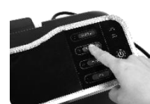
Obr. 2 Zvolte přísluš. operaci tlačítkem dokument/foto/cold
