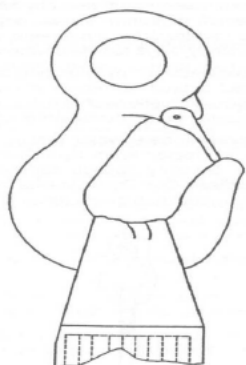
příklad č. 1 Nevyhovující zavěšení oka popruhu na háku s příliš malým poloměrem
